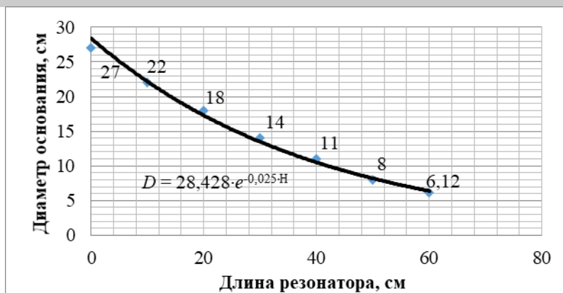
Рис. 6 – График, характеризующий экспоненциальную образующую резонатора
