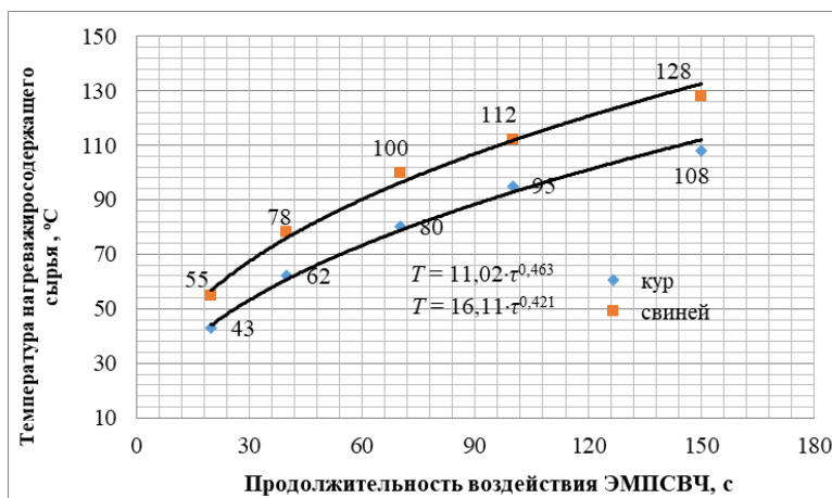
Рис. 4 – Динамика нагрева жиросодержащего сырья при удельной мощности генератора 5 Вт/г
