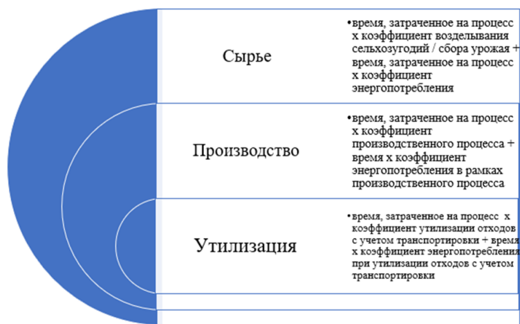
Рис.1 - Методика расчёта углеродного следа при производстве зерна
