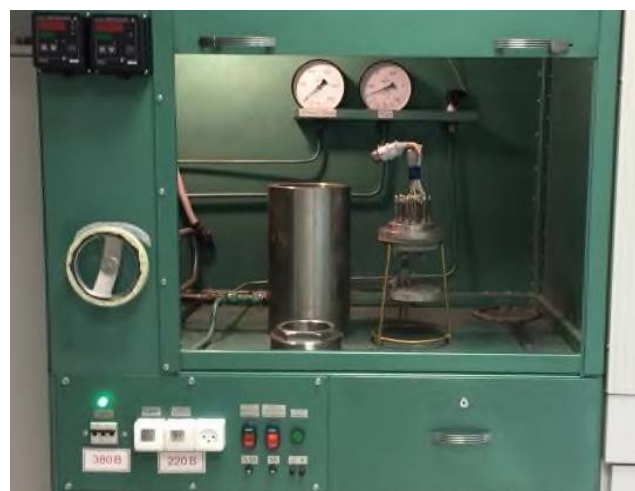
Рис. 1. Лабораторная установка для синтеза продуктов в режиме СВС-Аз
