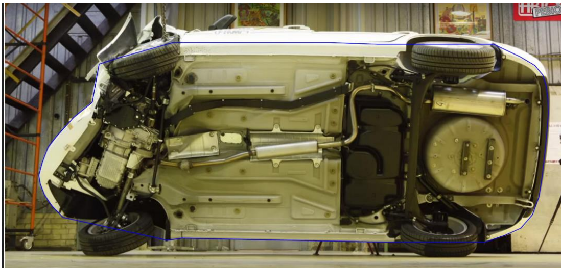
Рисунок 6 – Автомобиль ВАЗ-2192 после краш-теста: вид снизу с обведенным контуром кузова
