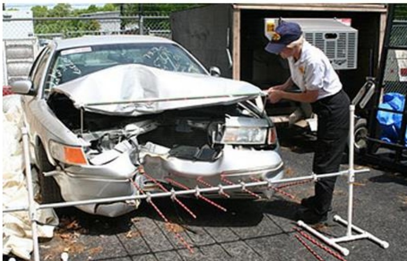
Рисунок 1 – Пример измерения деформации передней части автомобиля
