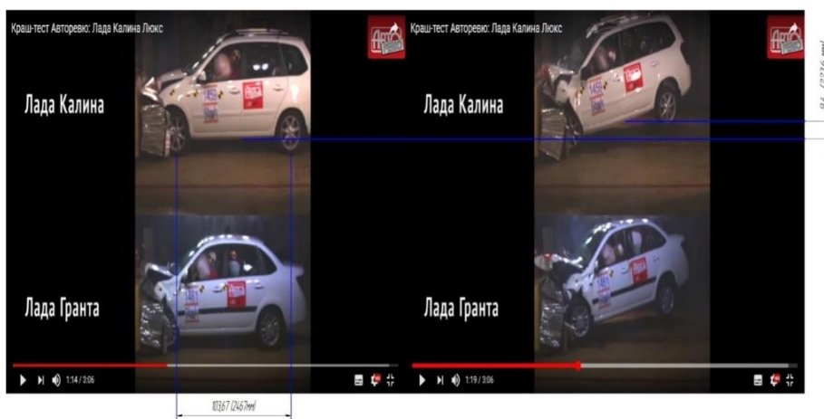
Рисунок 8 – Определение высоты подъема автомобиля в ходе краш-теста графоаналитическим способом
