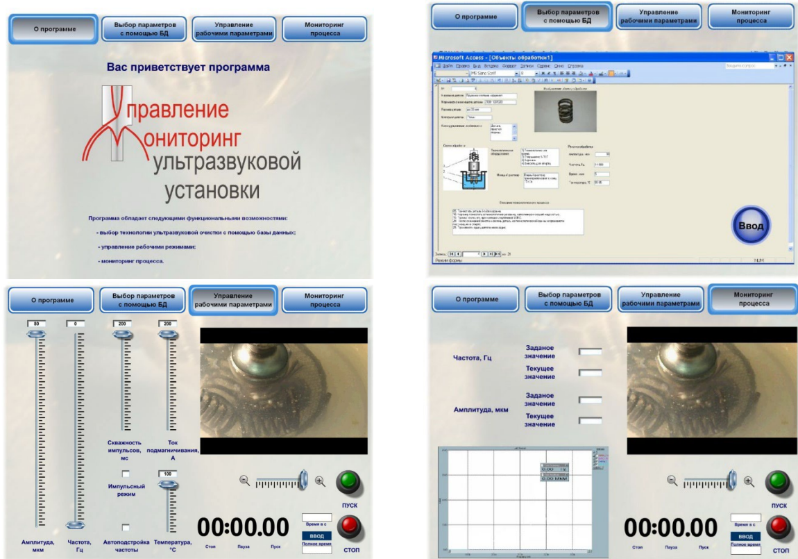
Рис. 1. Программная оболочка «Управление и мониторинг ультразвуковой установки»
