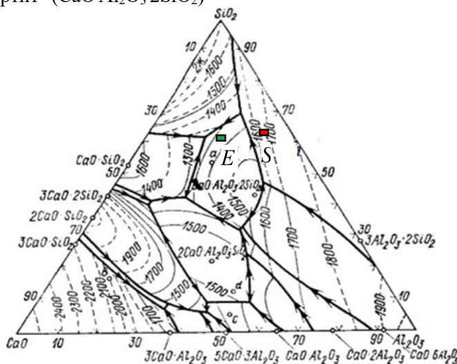
Рис. 3. Расположение экспериментальных составов стекол Е и S на диаграмме состояния CaO-Al 2 O 3 -SiO 2
