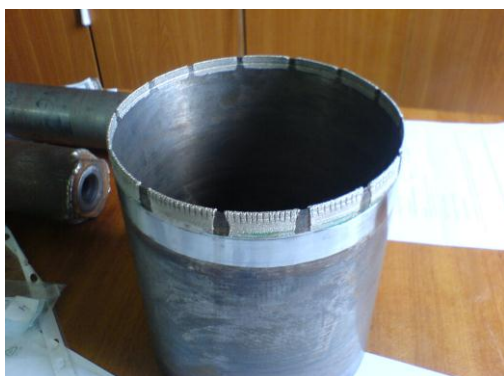
Рис. 1. Алмазное кольцевое сверло Fig. 1. Diamond ring drill
