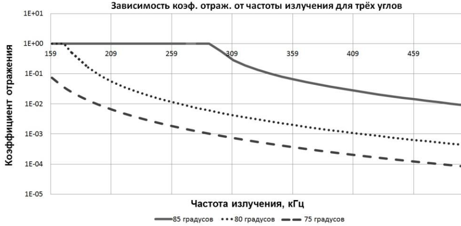
Рис. 7. Зависимость коэффициента отражения от частоты для трех углов падения на стенку канала при фиксированных значениях N_1 = 164 \text{ см}^{-3} и N_2 = 157 \text{ см}^{-3}
