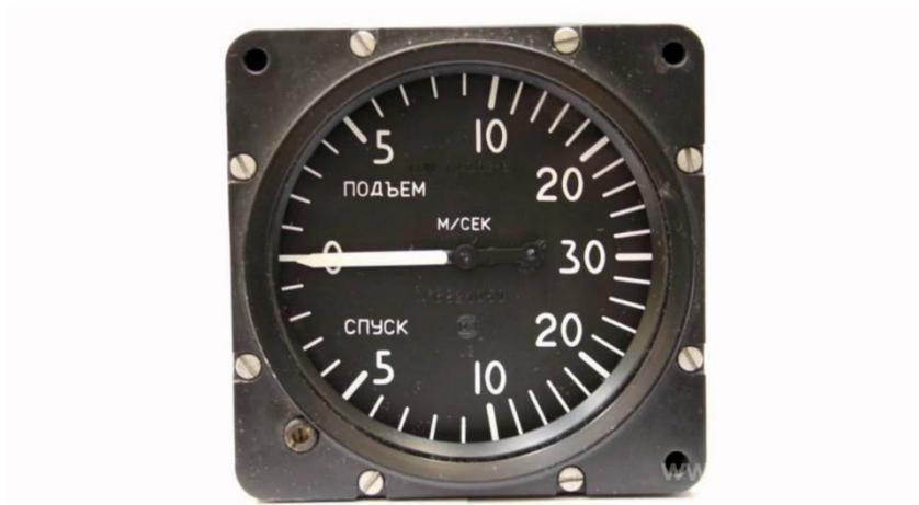
**Рис. 2.** Механический вариометр
