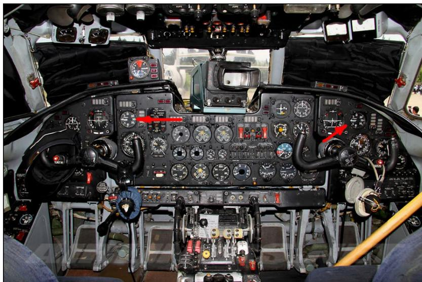
**Рис. 1.** Авиационные вариометры самолета Ан-26
