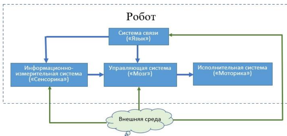
Рис. 2. Структурная схема интеллектуального робота Fig. 2. Block diagram of an intelligent robot
