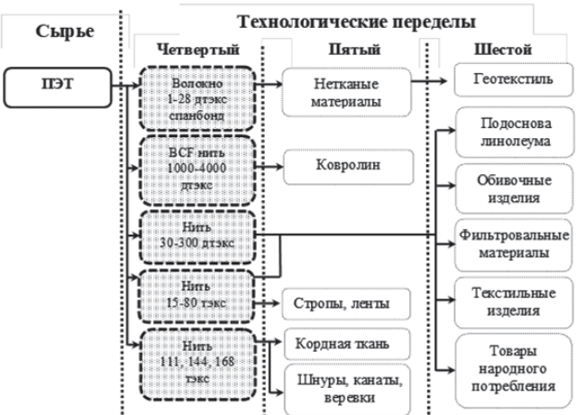
Рис. 5. Принципиальная схема переработки полиэтилентерефталата (ПЭТ)
