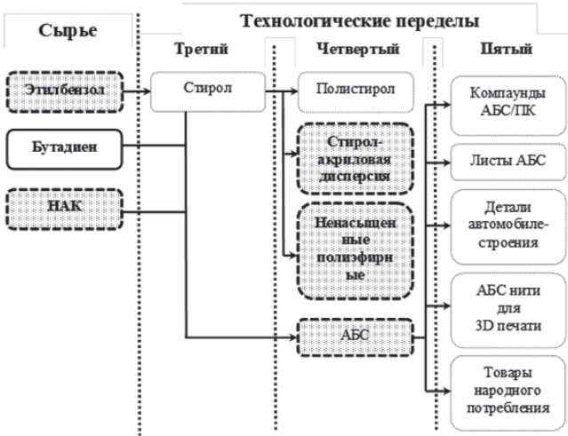
Рис. 2. Принципиальная схема переработки этилбензола
