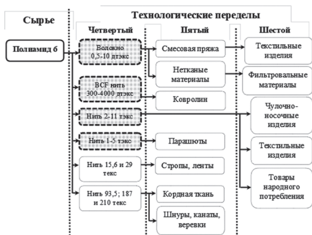
Рис. 3. Принципиальная схема переработки полиамида-6
