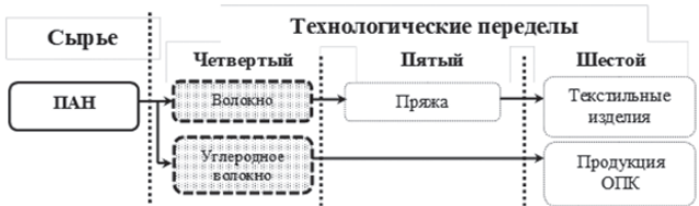
Рис. 6. Принципиальная схема переработки полиакрилонитрила (ПАН)
