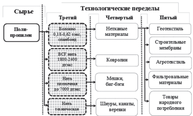
Рис. 4. Принципиальная схема переработки полипропилена
