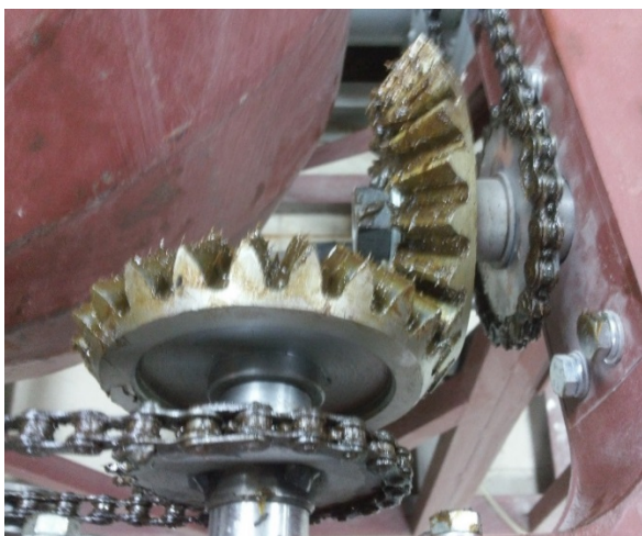
Рис. 7. Практическая реализация описываемой конической зубчатой передачи
