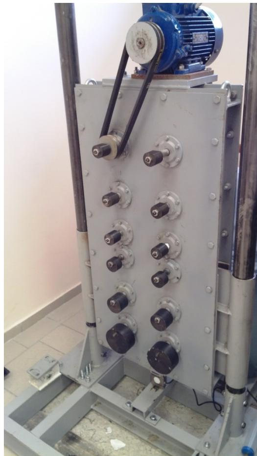
Рис. 8. Вибрационная установка в рабочем состоянии с тензометрическим датчиком силы
