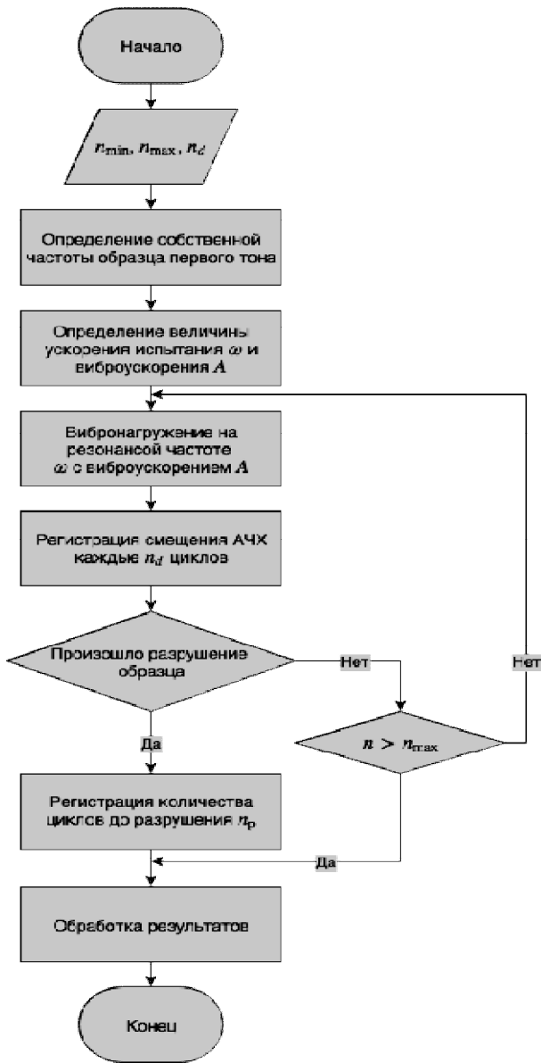
Рис. 2. Алгоритм испытания на циклическую прочность
