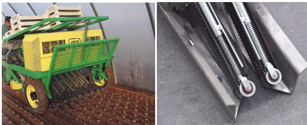
Рис. 11. Высадка рассады автоматической машиной в теплице и рабочий орган ленточного высаживающего аппарата
