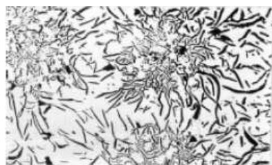
Рис. 8. Розеточное распределение пластинчатого графита ПГр7
