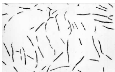
Рис. 5. Равномерное распределение графита ПГр1
