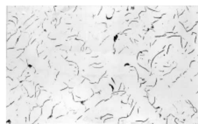
Рис. 7. Междендритное пластинчатое (направленное) распределение графита ПГр9
