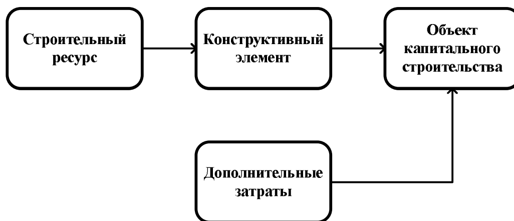
Рис. 2. Структура объектов ресурсно-технологического моделирования
