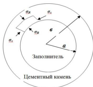
Рис. 1. Схема деформаций цементного камня при усадке:
