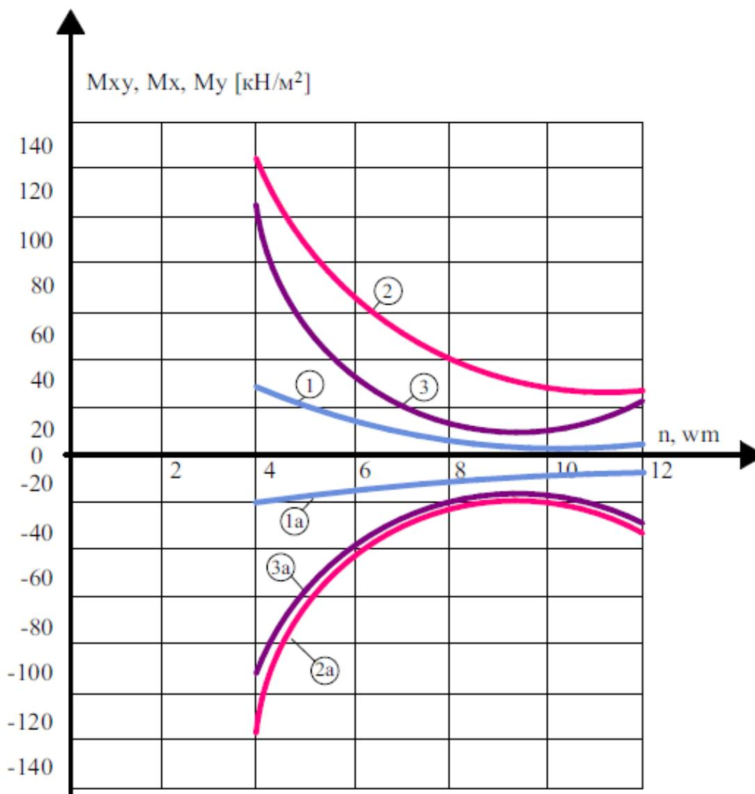
Рис. 5. Зависимость напряжений от изгибающих ( $M_x$  и  $M_y$ ) и крутящего ( $M_{xy}$ ) моментов от количества свай-опор при погружении оболочки ( $R = 15,0$ ;  $H = 5,0$  м): 1, 1a – от изгибающего момента в направлении оси  $y$ ; 2, 2a – от изгибающего момента в направлении оси  $x$ ; 3, 3a – от крутящего момента в осях  $xy$ .
