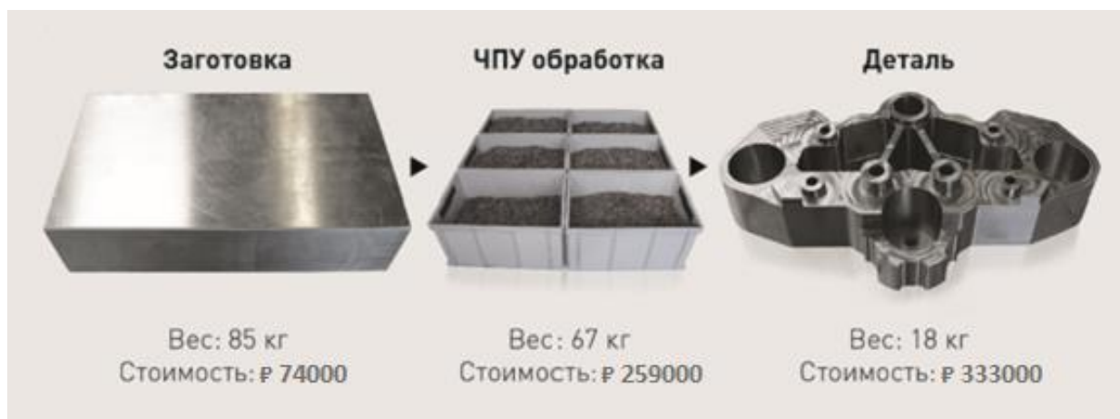
Рис. 2. Изготовление детали по традиционной технологии
