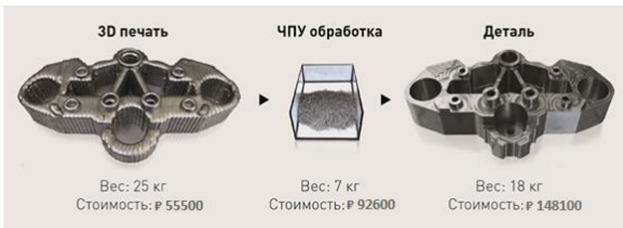
Рис. 3. Изготовление детали по аддитивной технологии 3DMP
