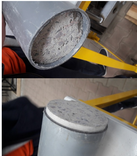
Рис. 3. Деформация образца в процессе испытания нагрузкой
