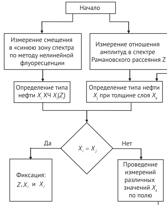
Рис. 6. Вариант конкретной реализации комплексного алгоритма определения параметров слива нефти в море
