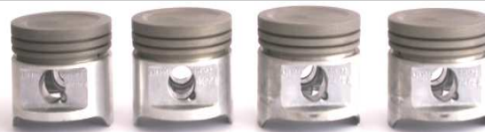
Рисунок 1 – Общий вид комплекта поршней с теплоизолирующим покрытием рабочих поверхностей головок
