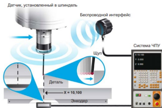
Рис. 1. Принцип работы контактного датчика [5]
