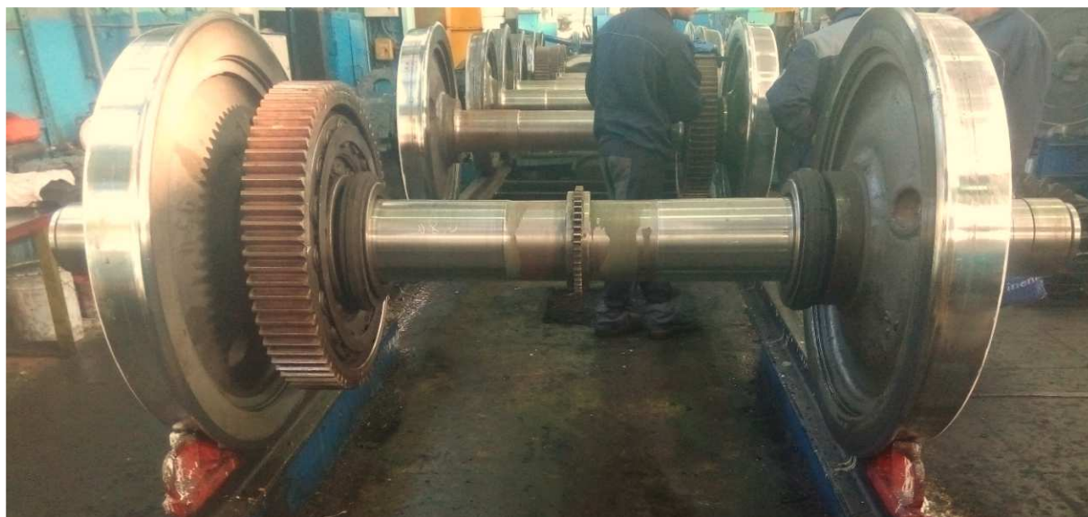
Рис. 2. Колёсная пара локомотива с восстановленной поверхностью
