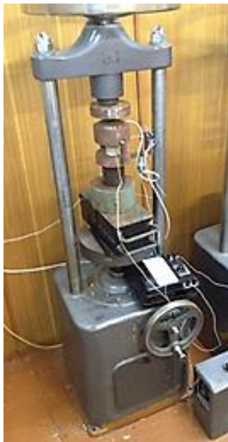
Рис. 1. Испытательная установка: 1 – оправка, 2 – образец, 3 - центрирующее устройство, 4 - месдоза
