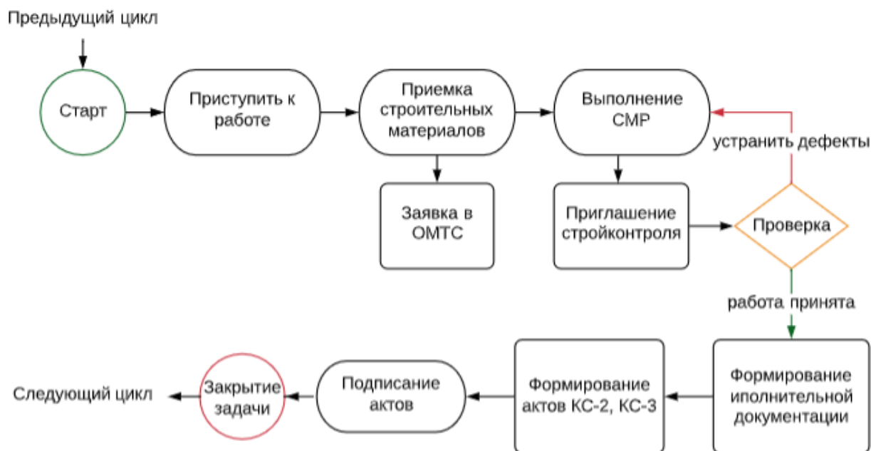
Рис. 14. Блок-схема процесса приёмки строительно-монтажных работ
