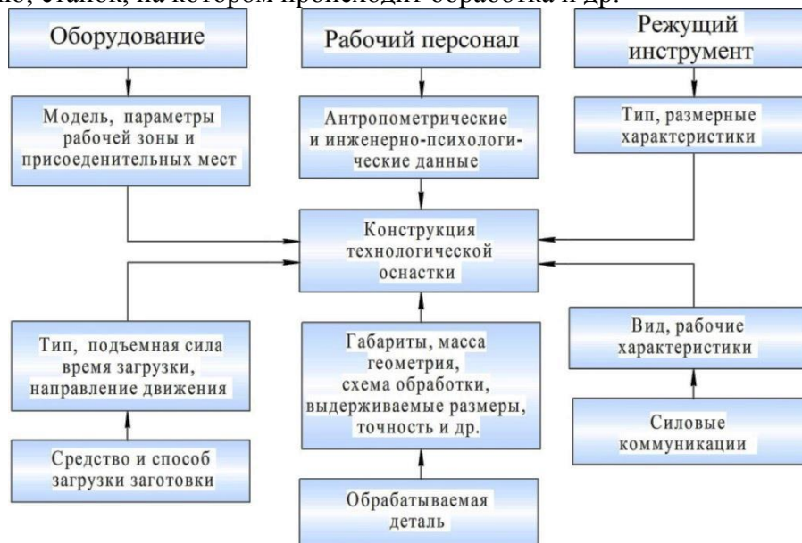
Рис. 1. Связи конструкции станочной технологической оснастки с внешними объектами
