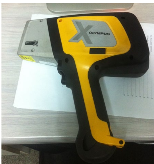
Рис. 3. pXRF-анализатор Olympus Delta Professional DP 4000
