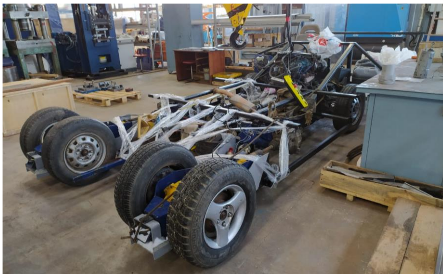
Рис. 4. Конструкция буксировщика на стадии сбора
