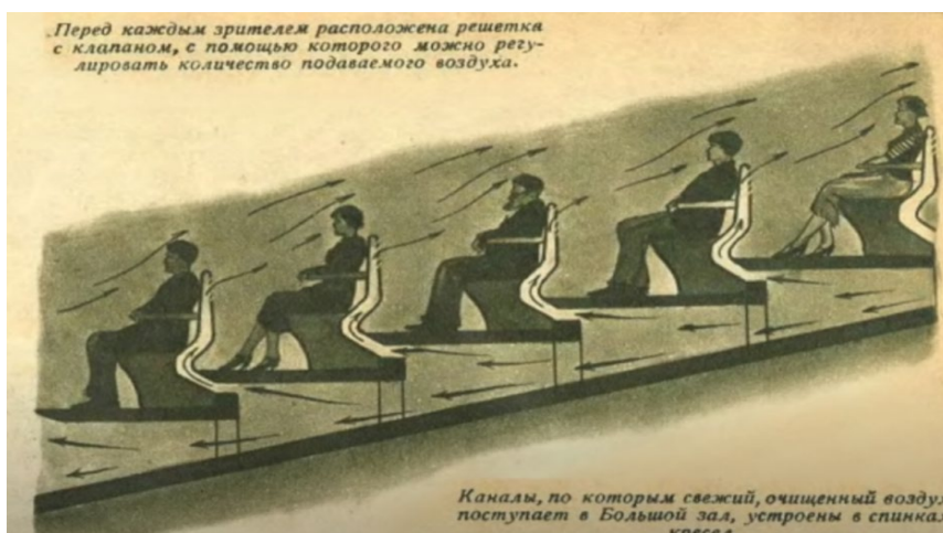
Рис. 5. Технические устройства системы кондиционирования Дворца Советов
