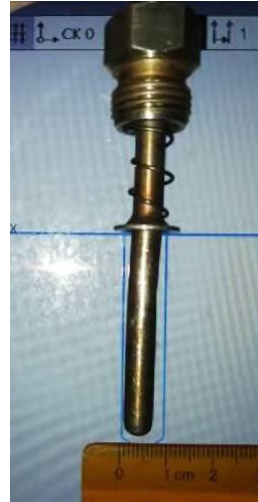
Рис. 13. Изогнутый датчик и перегретая форма
