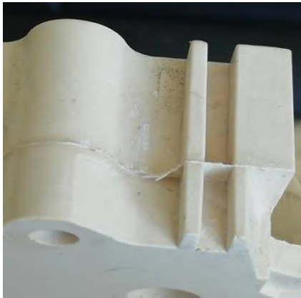
Рис. 7. Облой и «апельсиновая корка» на поверхности формы
