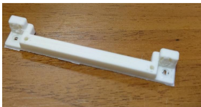
Рис. 3. Детали после печати из TOTAL GF-30 Fig. 3. Details after printing from TOTAL GF-30
