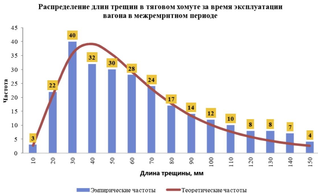
Рис. 8. Гистограмма распределение длин трещин в тяговом хомуте за время эксплуатации вагона в межремонтном периоде
