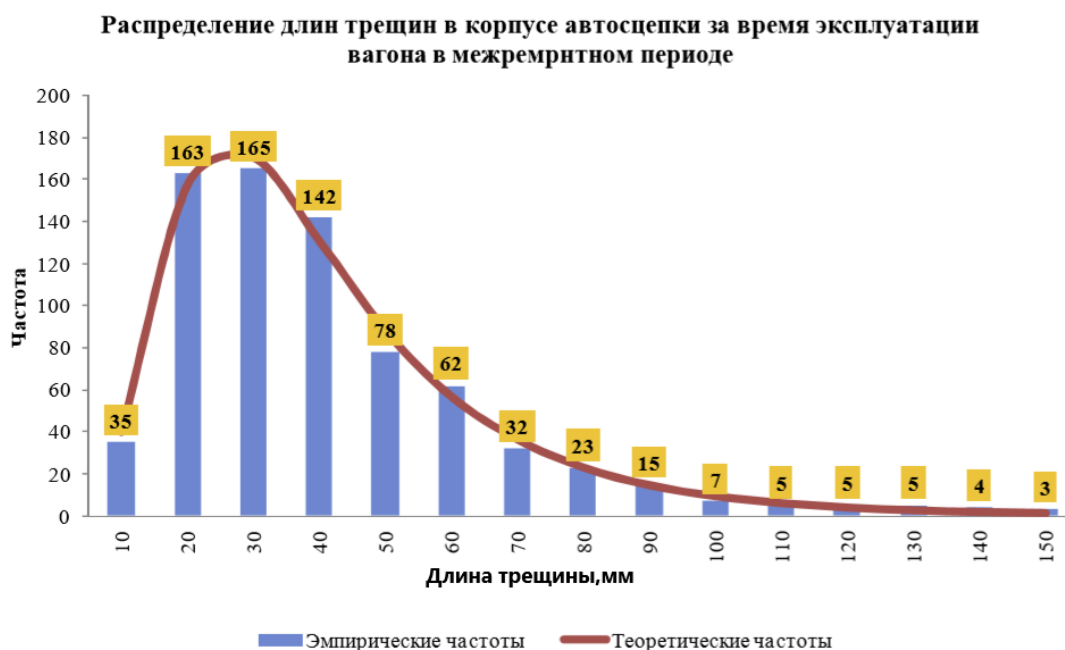
Рис. 7. Гистограмма распределение длин трещин в корпусе автосцепки за время эксплуатации вагона в межремонтном периоде
