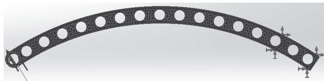
**Рис. 14.** Нагружение рельса при исследовании в SolidWorks
