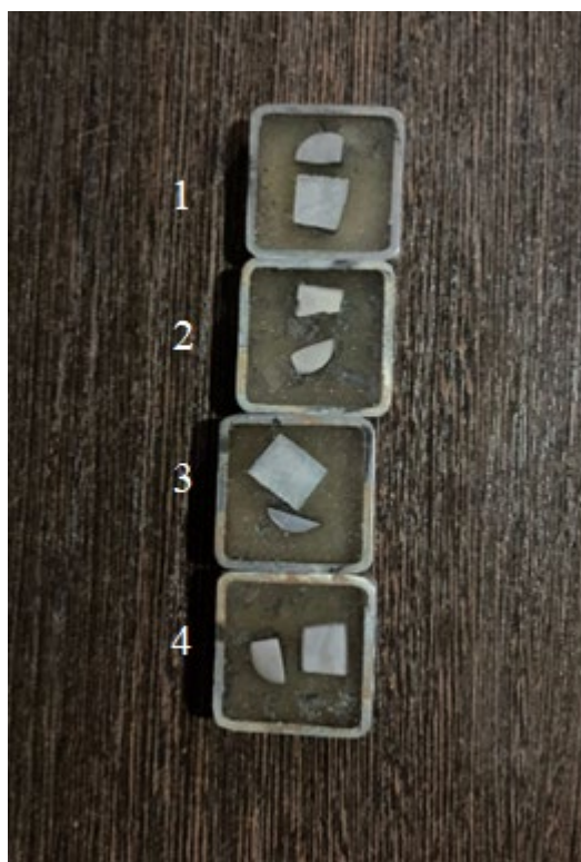
Рис. 1. Образцы, залитые в эпоксидную смолу
