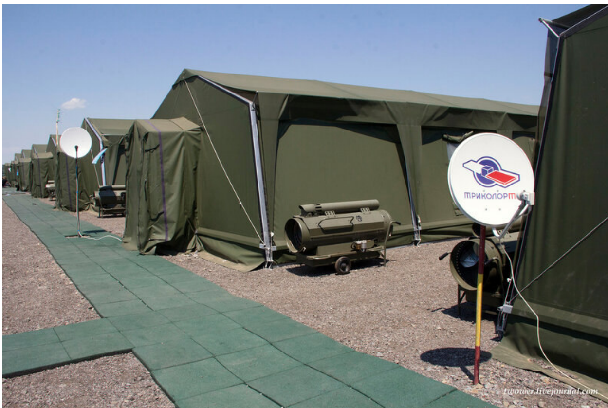
Рис. 4. Входная зона палатки автономного полевого лагеря АПЛ-500 с системой обогрева приставной тепловой пушкой. [Электронный ресурс]. – URL: https://www.arms-expo.ru/articles/armed-forces/ustroystvo-avtonomno-polevogo-lagerya-apl-500/ (дата обращения 23.07.2023)
