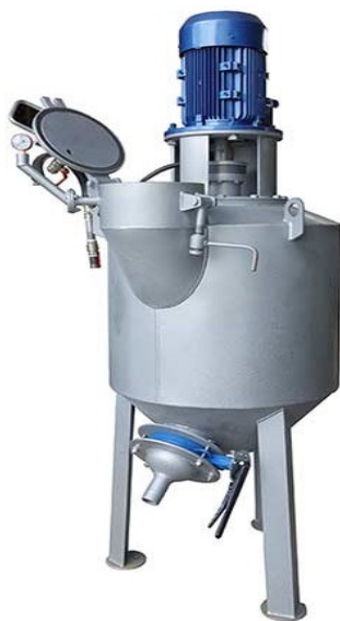
Рис. 2. Лопастной смеситель с вертикальным расположением лопастных валов SATEC:
