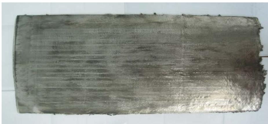
Рис. 2. Фотография листового композиционного полуфабриката после сварки взрывом
