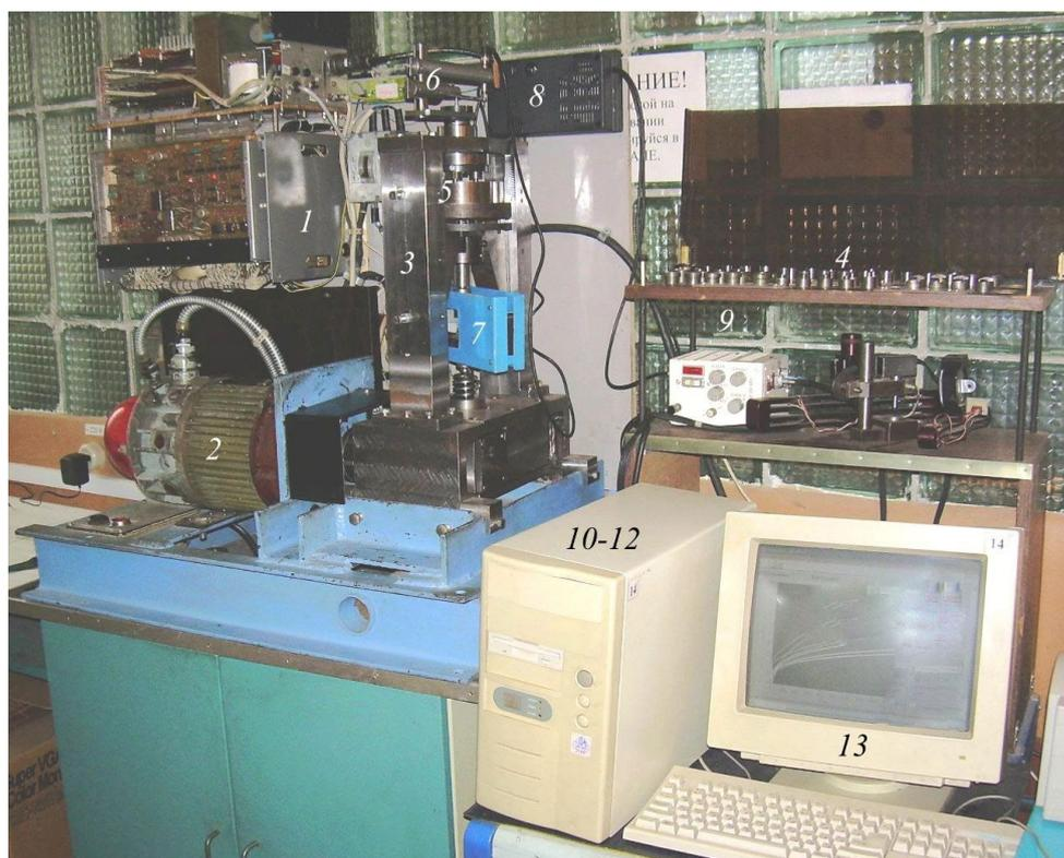
**Рис. 1. АСНИ контактной жесткости деталей машин:**
