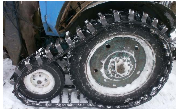
Рисунок 5. Задняя ось трактора МТЗ, переоснащенного на полугусеничный ход Figure 5. The rear axle of the MTZ tractor, re-equipped with a half-track
