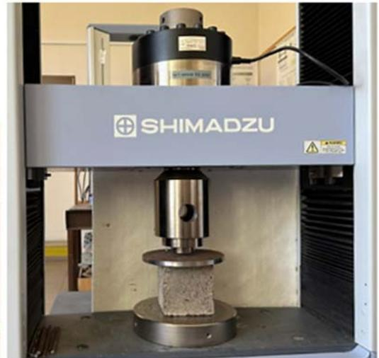
Рисунок 1. Образцы грунта и тест-машина
