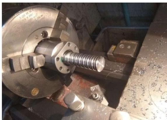
Рис. 5. Черновая обработка винтов ШВП на токарном станке 16K20
