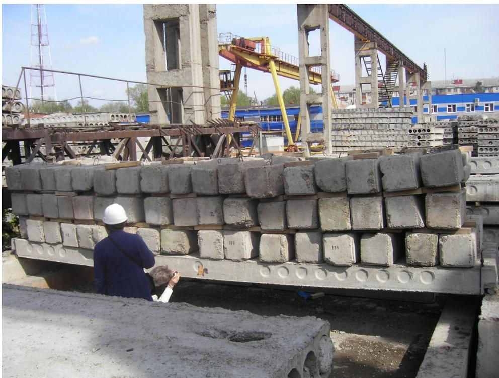
Рис. 3. Испытание плиты перекрытия на территории завода строительных конструкций «РАФФ», г. Казань Республики Татарстан
