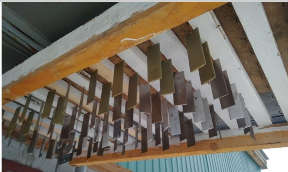
Рис. 1 – Развешивание образцов под навесом
