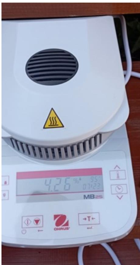
Рис. 4 – Общий вид прибора для определения относительной влажности ОНАУС MB-25
