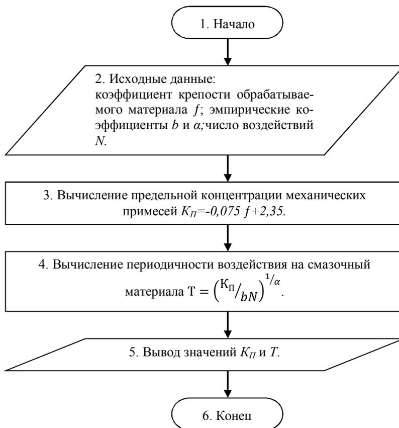
Рис. 1 Алгоритм расчета периодичности воздействия или замены смазочного материала в системе смазки ДРО
