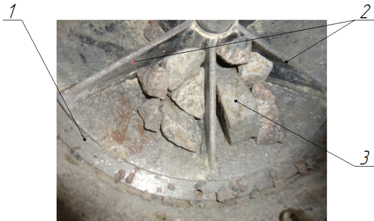
Рис. 8. Заклинивание кусков гранита между ребрами и ступицей в роторе мельницы: 1 – ротор; 2 – ребра; 3 – заклиненный кусок материала
