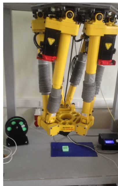
Рис. 6. Робототехнический комплекс для 3D-печати изделий
