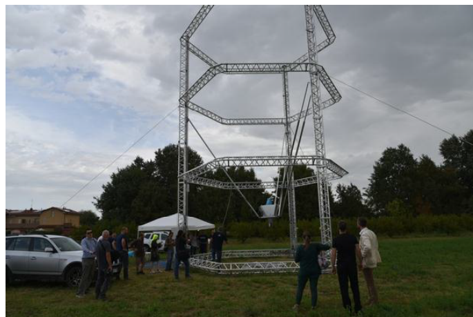
Рис. 4. Строительный роботизированный комплекс The BigDelta
