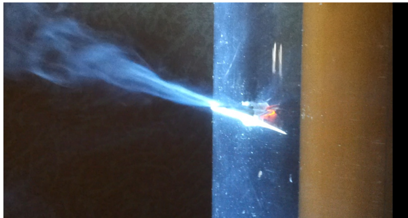
Рис. 3. Задымление установки при полном перекрытии байпасной камеры
